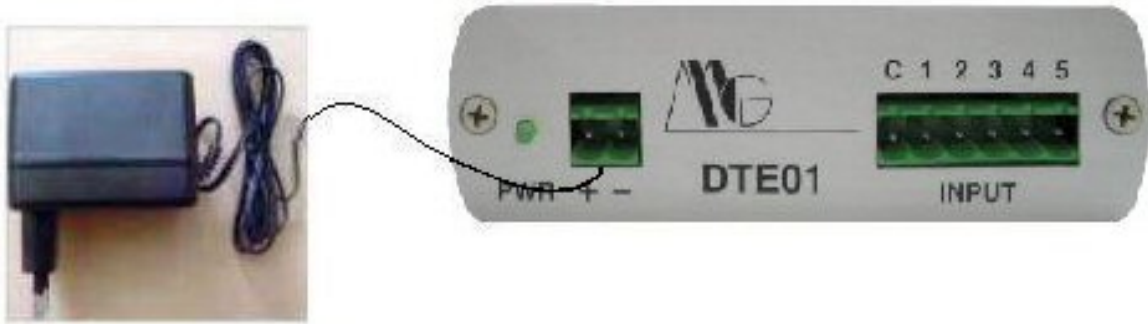
Figura 7: Connessione alimentazione DTE01
