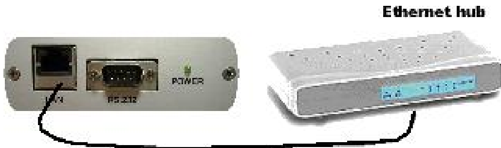
Figura 5: STE02: Collegamento alla rete
